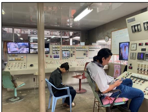
ภาพที่ 8 พนักงานควบคุมระบบสายพานลำเลียงกากอ้อย
