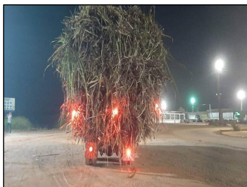
ภาพที่ 51 ติดสัญญาณไฟแดง ไว้บริเวณด้านซ้าย-ขวาของตัวรถ
