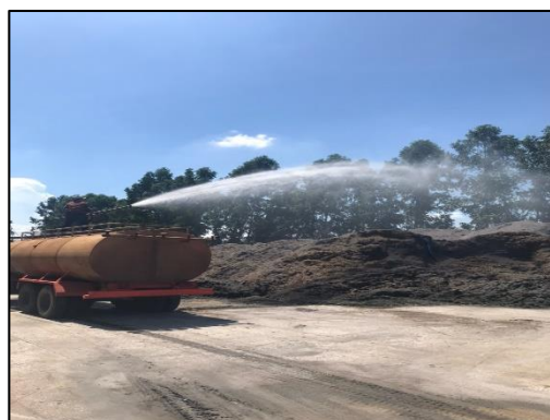
ภาพที่ 38 นีดพรมน้ำรอบลานกองเก็บกากอ้อย
